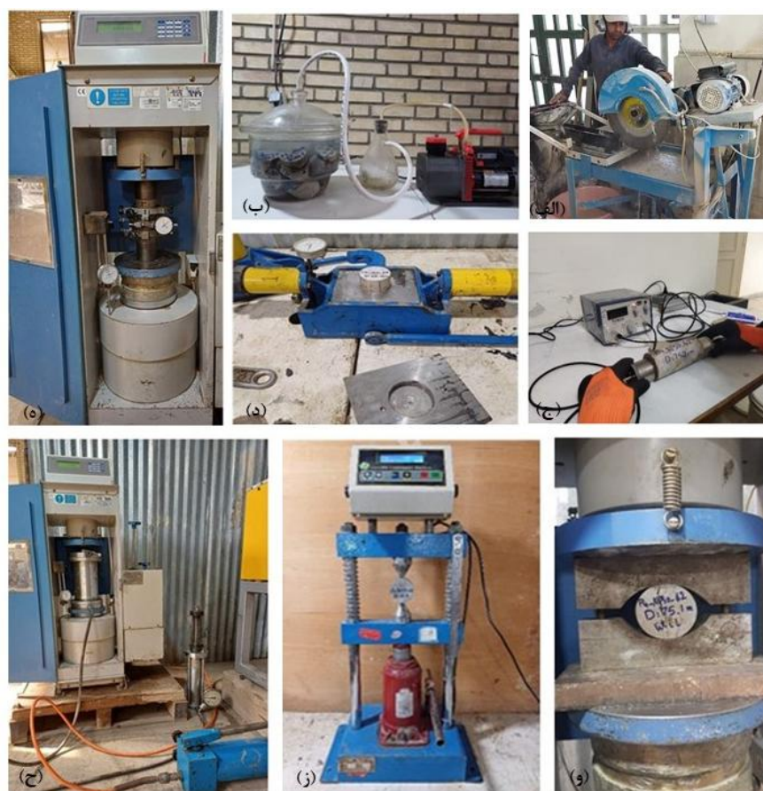
شکل ۴- انجام آزمون‌های آزمایشگاهی بر روی نمونه‌های مختلف؛ (الف) آماده‌سازی نمونه، (ب) تعیین خواص فیزیکی، (ج) اندازه‌گیری سرعت موج، (د) آزمون برش مستقیم، (ه) آزمون تک‌محوری، (و) آزمون برزیلین، (ز) آزمون بار نقطه‌ای و (ح) آزمون سه‌محوری.
