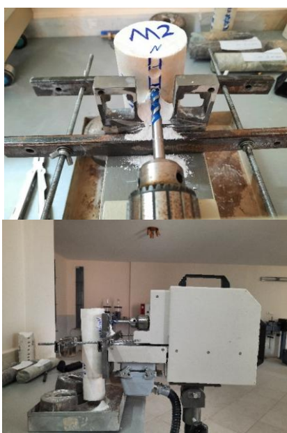
شکل ۱۱- نمایی از چیدمان انجام آزمایش حفاری .
