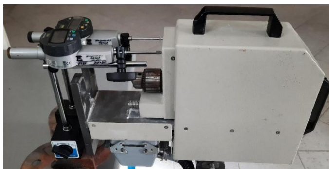
شکل ۴- نصب حسگرهای جابجایی سنج با دقت ۱ میکرون بعنوان مرجع برای واسنجی جابجایی دستگاه.
