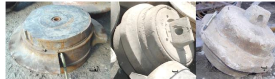
شکل ۴. نمونه‌هایی از انواع سایش برش‌دهنده دیسک مشاهده شده در پروژه تونل قمرود: (الف) شکستگی حلقه دیسک، (ب) سایش نامتقارن، و (ج) سایش معمولی.
