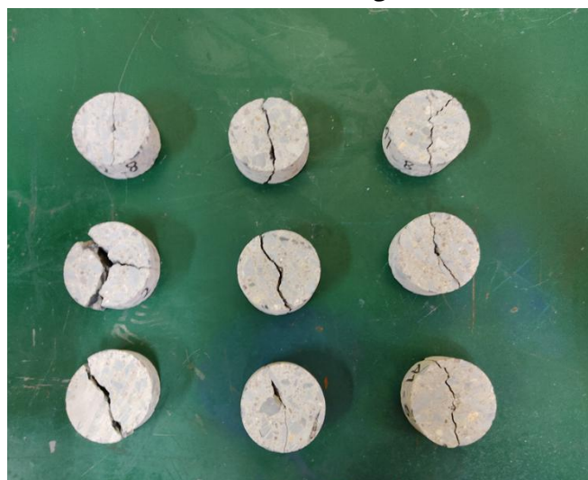
شکل ۴. نمونه‌ها بعد از شکست در آزمایش خمش چهار نقطه‌ای
