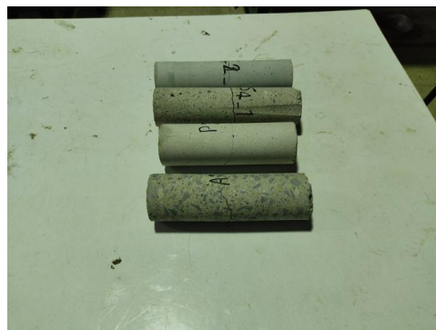
شکل ۴. نمونه‌ها بعد از شکست در آزمایش خمش چهار نقطه‌ای
