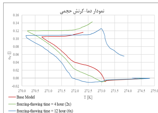
شکل ۵- نمودار دما-کرنش حجمی با تغییر زمان انجماد/ذوب برای یک نقطه میانی مدل
