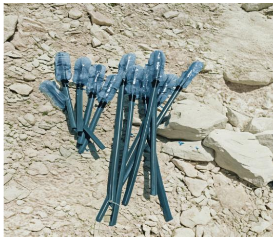
شکل ۲- فاصله اندازه‌ها (سوپر پلاگ) تهیه شده برای ایجاد ستون هوا درون چال انفجاری
