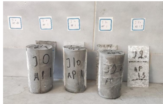
شکل ۶: نمونه‌های تولید شده جهت اعتبارسنجی نتایج آزمایشگاهی و عددی
