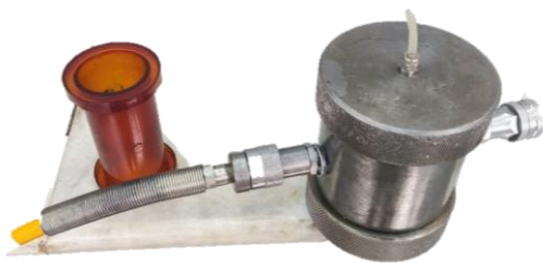
شکل ۷: غشا لاستیکی سلول هوک جهت اعمال فشار جانبی به نمونه
