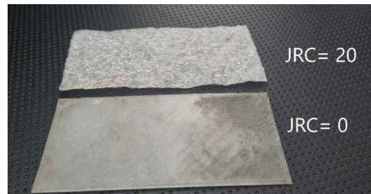
شکل ۵: نمونه قطعات چاپ شده برای سطوح زبری متفاوت
