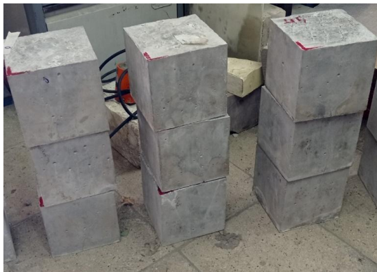
شکل ۷- نمونه‌های ساخته شده سنگ دارای شبکه درزه.
