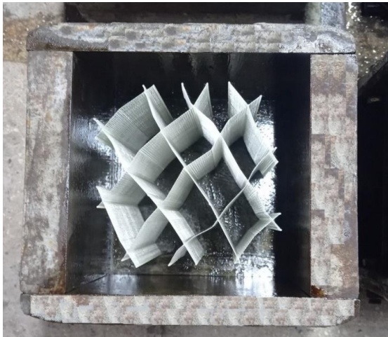
شکل ۶- قرار دادن شبکه ناپیوستگی ساخته شده با چاپگر سه‌بعدی در قالب فلزی.
