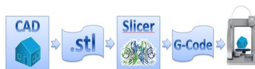
شکل ۲- مراحل ساخت نمونه از مرحله طراحی تا اجرا توسط پرینتر سه‌بعدی.
