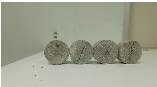
شکل ۱۰- ترک‌های کششی ایجاد شده ناشی از مقاومت کششی برزیلی
