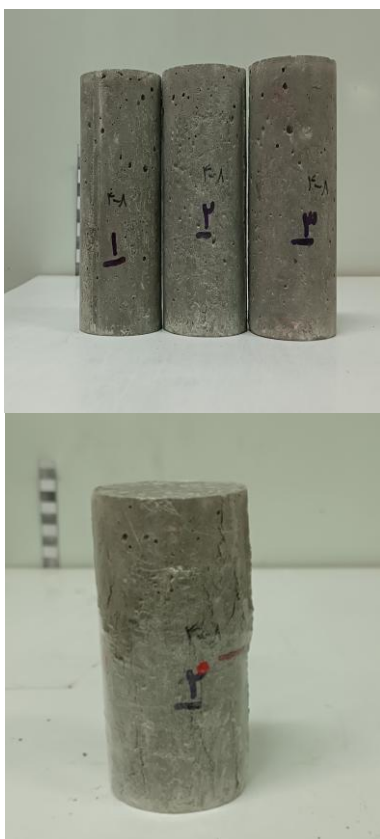
شکل ۶- نمونه‌های مقاومت فشاری تک‌محوری قبل و بعد از شکست
