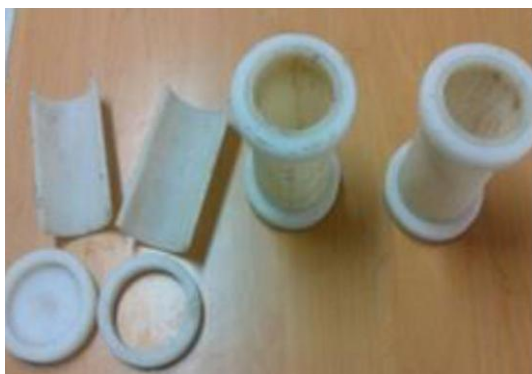
شکل ۱- قالب‌های به کار رفته برای ساخت نمونه‌های برزیلی و مقاومت فشاری
