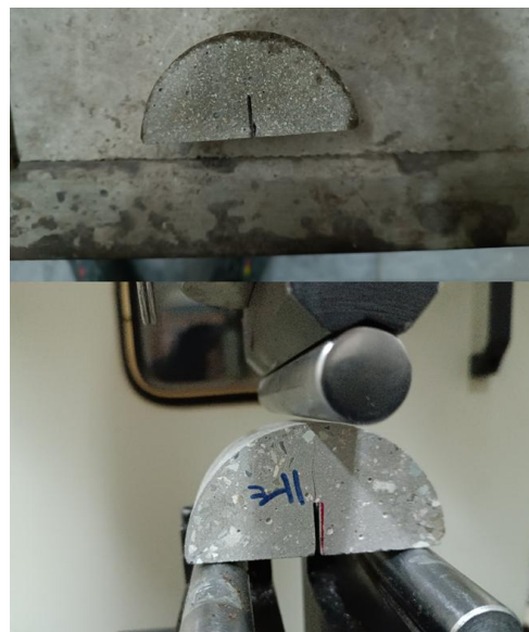
شکل ۱۱- نمونه‌های SCB قبل و بعد از شکست
