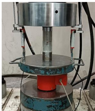
شکل ۲- نمایشی از دستگاه سنتام و انجام آزمایش مقاومت فشاری تک محوری
