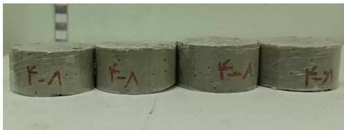
شکل ۳- نمونه‌های آماده شده برای انجام آزمایش مقاومت کششی برزیلی
