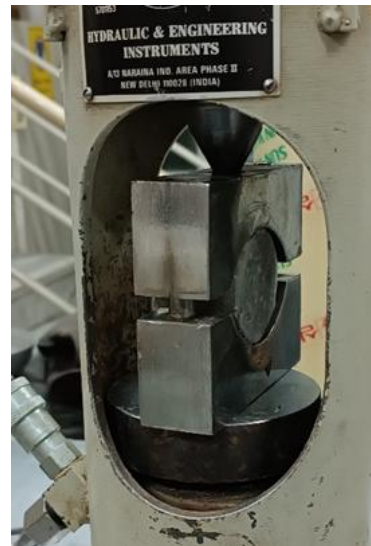
شکل ۴- نمایشی از دستگاه به کاررفته برای انجام آزمایش مقاومت کششی برزیلی
