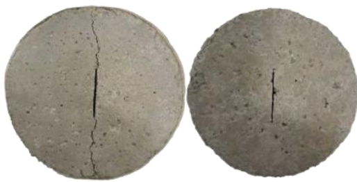
نمونه دیسک برزیلی حاوی ترک مرکزی ملات سیمان قبل . بعد از شکست
