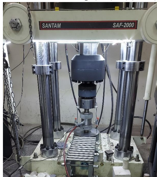
شکل ۸- تصویر انجام آزمایش مقاومت فشاری سه محوری در آزمایشگاه مکانیک سنگ دانشگاه تربیت مدرس از این آزمایش میزان چسبندگی (c)، زاویه اصطکاک داخلی (ϕ) و مقاومت فشاری سه محوری حاصل می گردد.
