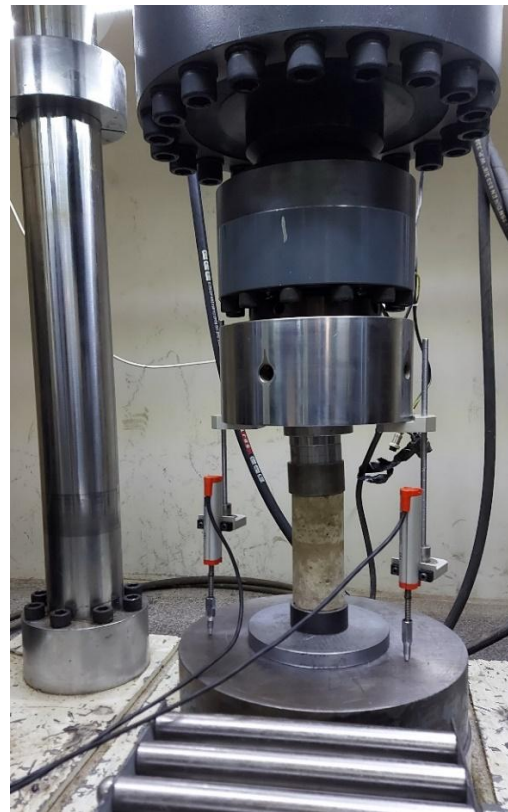
شکل ۴- فرآیند انجام آزمون مقاومت فشاری تک محوری روی نمونه حاوی ۲۰ درصد ورمیکولیت
