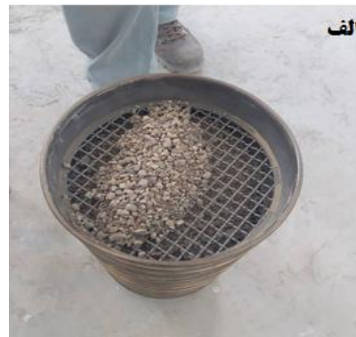
شکل ۱- آزمایش دانه بندی ماسه (الف) وزن ماسه باقی‌مانده روی هر الک، (ب) دانه‌بندی ماسه به‌وسیله لرزاننده
