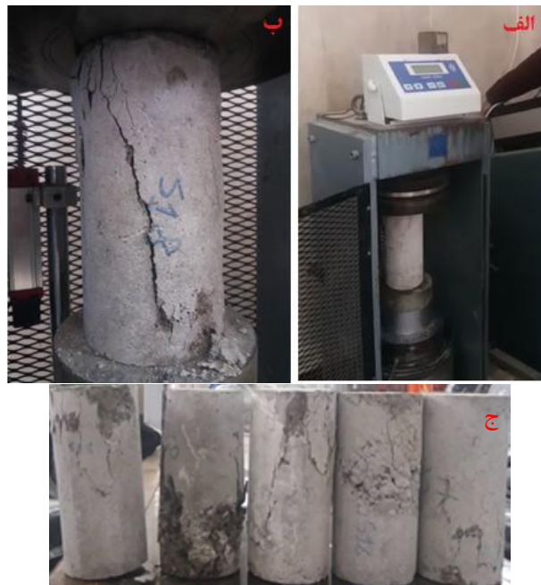
شکل ۴- آزمایش مقاومت فشاری تک محوره (الف) دستگاه بارگذاری (ب) شکست نمونه تحت بارگذاری (ج) الگوهای
