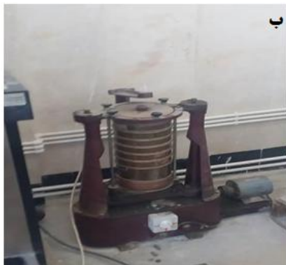
شکل ۱- آزمایش دانه بندی ماسه (الف) وزن ماسه باقی‌مانده روی هر الک، (ب) دانه‌بندی ماسه به‌وسیله لرزاننده
