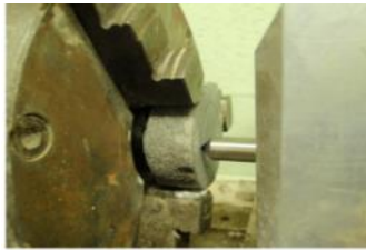
شکل ۲ - نمایی از دستگاه آزمایش اصلاح شده سایش سرشار [۷].
