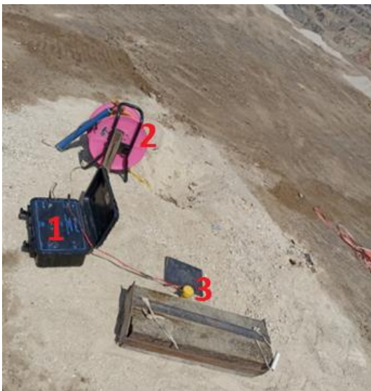
شکل ۸- نحوه چیدمان تجهیزات آزمایش لرزه نگاری درون چاهی
