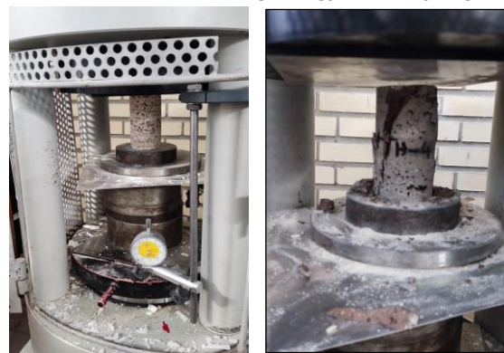
شکل ۳- آزمون مقاومت فشاری تک محوری
